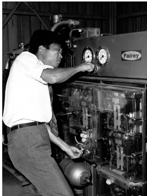
Un estudiante provoca terremotos en miniatura que son enviados a la "mesa de temblores" por un aparato hidráulico, en Japón en 1969. Un programa de la agencia de Naciones Unidas para el Desarrollo (PNUD) – del que UNESCO asegura la puesta en marcha – asiste al gobierno japonés en la formación de expertos de países en desarrollo para combatir los efectos de los seísmos.
