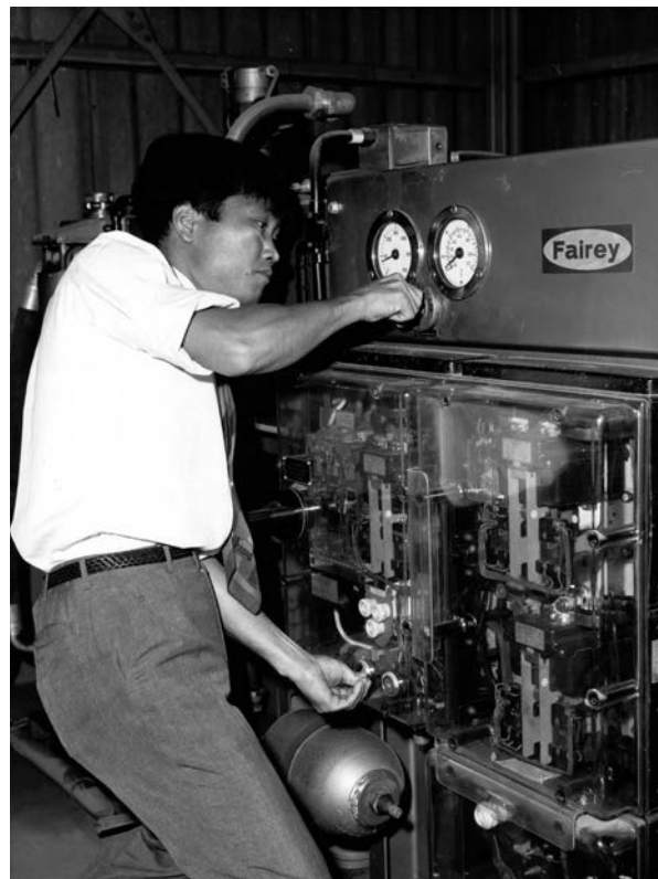
1969年，日本东京，一名学生模拟由液压装置传到“振动台”上的微型地震。这是联合国开发计划署（UNDP）与日本政府的合作项目，联合国教科文组织担任执行机构。项目旨在对国际地震和地震工程研究所的专家进行培训，以帮助发展中国家应对地震造成的影响。
